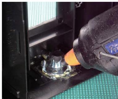
↓ 1/4inch爪付ナットをボンド(G17)で接着後、ホットボンドで全体を固定する
