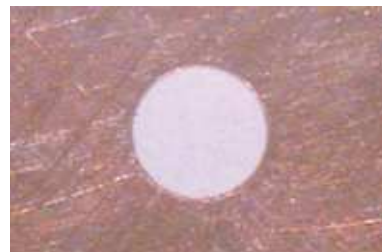
銅箔にあげた直径0.30mmのピンホール
