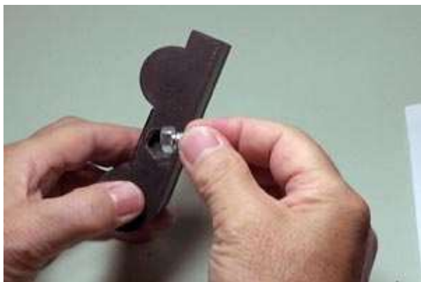
D-① 三脚穴に 1/4 インチ六角ナットが入るかは、同じ大きさの六角ボルトを入れて確認する
