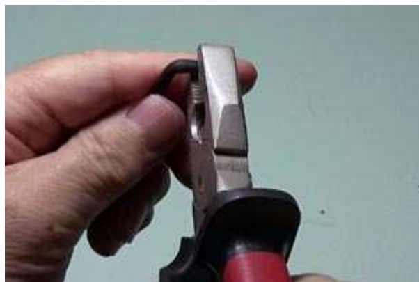
F-④ 端から 1cm ちょつとの所で直角に曲げる
