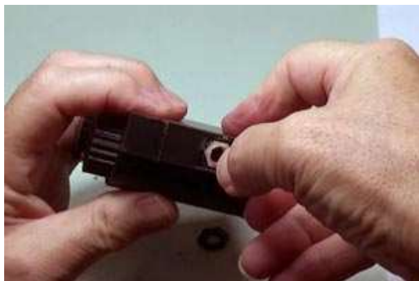
D-② ボンド G17 で六角ナットを接着する
