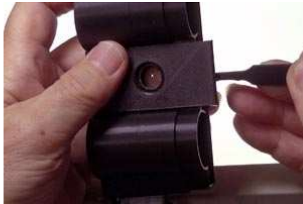
G-④ ピンホールがシャッターの穴の中央に来るように貼る
