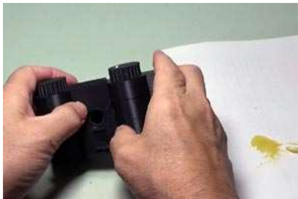
C-④ シャッター引き蓋を入れて圧着する
