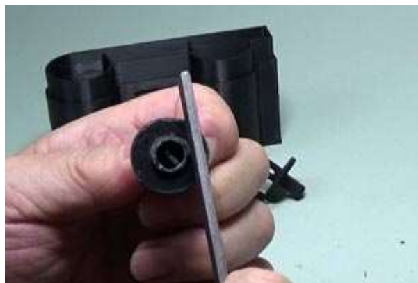
前処理-② 部品のバリをヤスリで落とす
