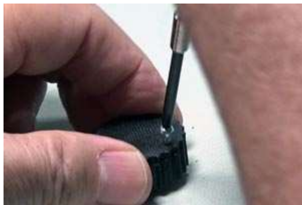
A-② 巻き戻しノブの穴にネジを入れる
