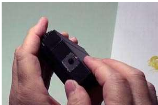
D-④ 横位置の三脚穴も同様に、六角ナットとフタをボンド G17 で接着する
