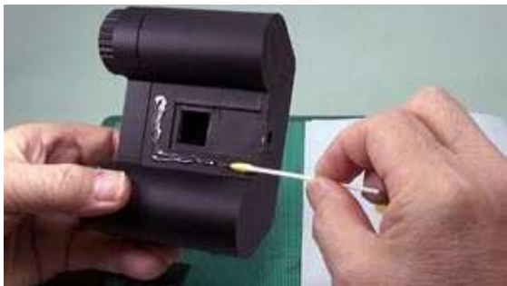
①シャッターカバーにボンドを塗る。
