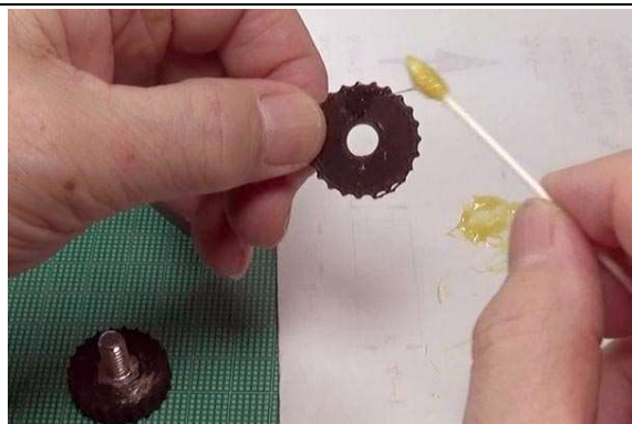
③ノブのカバーにボンドを塗る。
