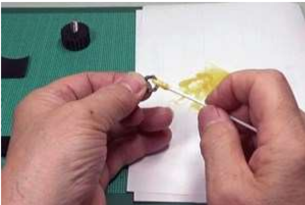
⑦ナットにボンドを塗り接着する。
