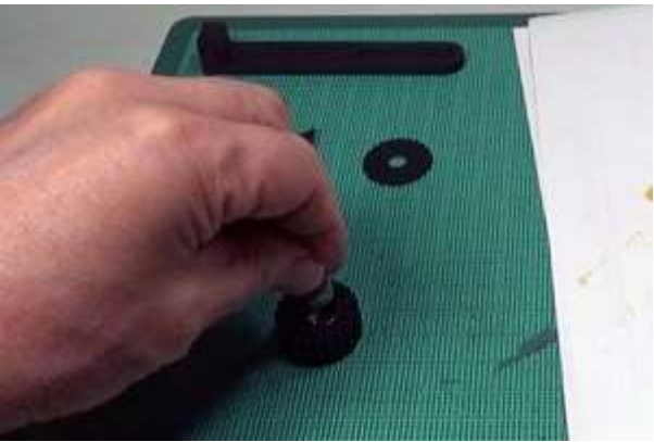
③さらにボルトを接着する。
