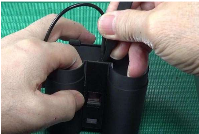
⑤ピンホールがシャッターの中央に来るようにカメラ内部に貼り付ける。
